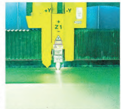
Das Faserlaser-Schneidgerät bei der Bearbeitung einer Aluminiumplatte.
