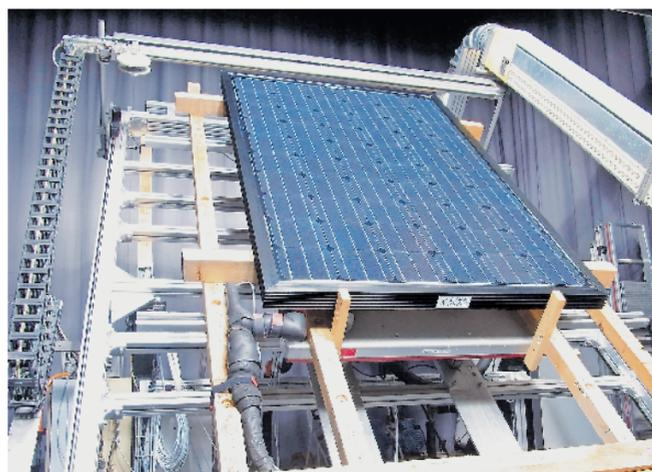
Ein kombiniertes PVT-Solarmodul auf dem Prüfstand des Instituts für Solartechnik in Rapperswil.
