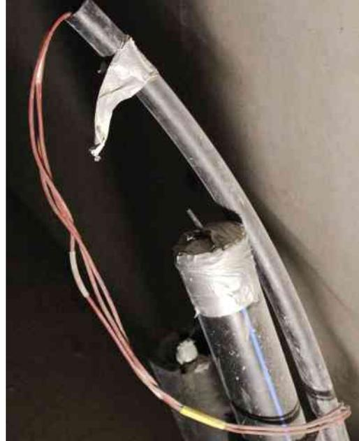
Für das Monitoring dienen die in drei Erdwärmesonden eingebrachten Messfühler in 50, 110 und 170 Meter Tiefe zur Ermittlung des saisonalen Temperaturverlaufs.
